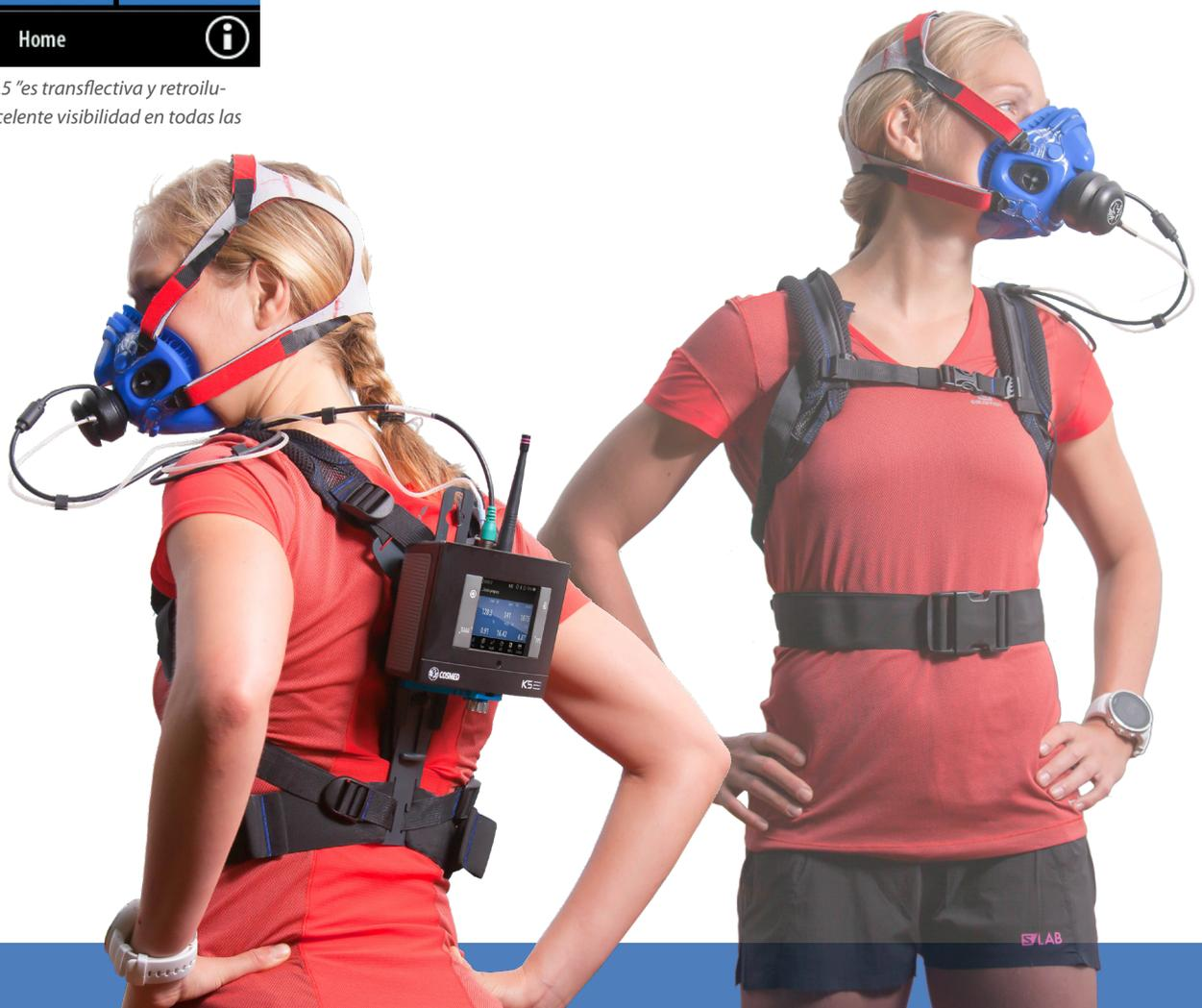
“El K5 cumple con el estándar IP54. Fue diseñado para uso en exteriores y garantiza la máxima protección contra el agua (lluvia o sudor) y el polvo.”
