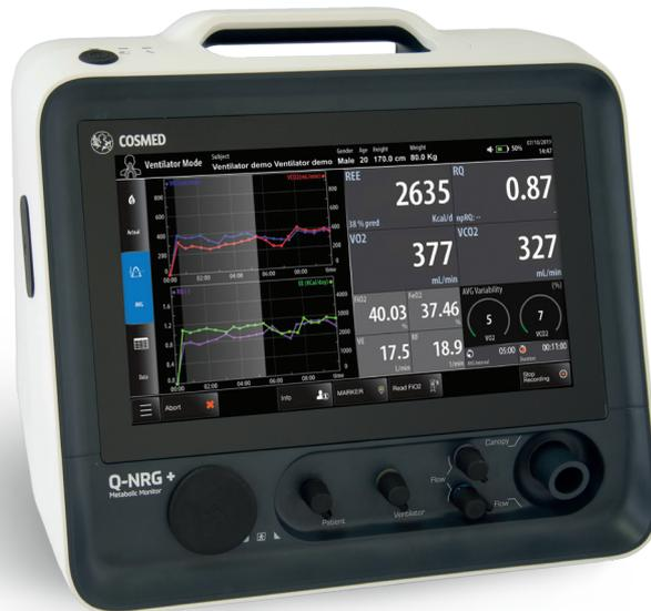
Das Q-NRG ist das erste indirekte Kalorimeter, das von COSMED, dem weltweit führenden Unternehmen in der Entwicklung von Stoffwechselsystemen für klinische und leistungsbezogene Anwendungen entwickelt wurde. Es ist speziell für die Messung des Ruheenergieverbrauchs (REE) bei mechanisch Beatmeten oder Spontanatmenden sowie bei gesunden Personen konzipiert.
