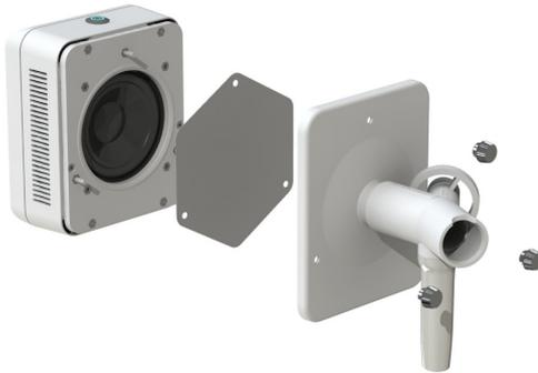
Q-i2m schematischer Aufbau. Die interne Membran kann einfach und schnell gereinigt oder vom Anwender ausgetauscht werden.
