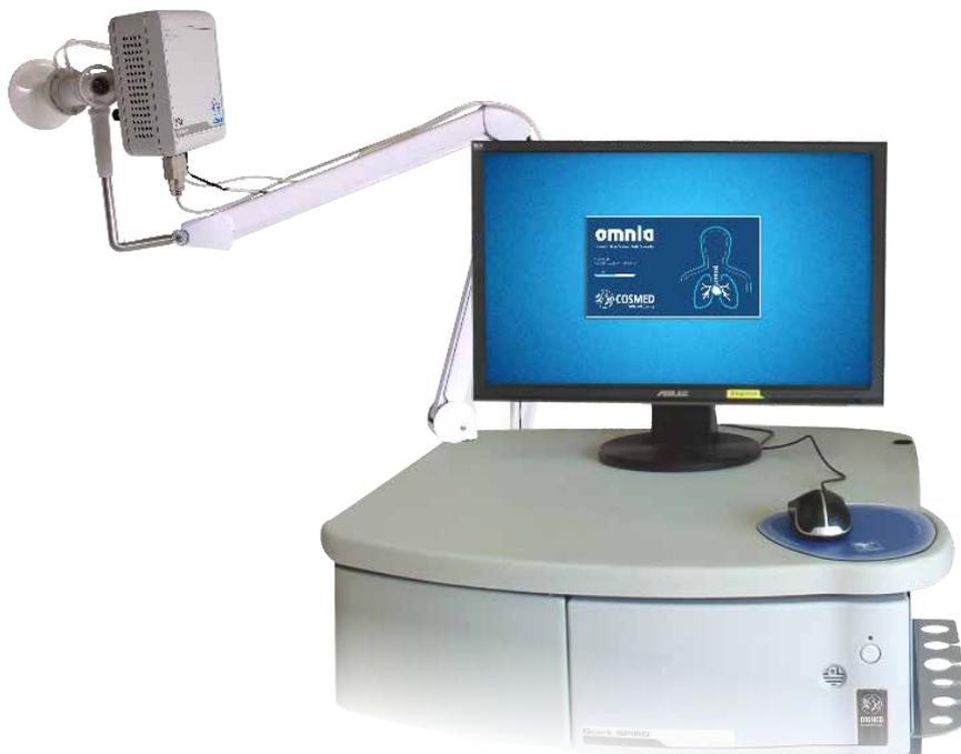
Le Quark SPIRO est un spiromètre de laboratoire modulaire moderne qui permet de réaliser tous les tests standard de spirométrie mais aussi, grâce à ses modules optionnels, de mesurer la résistance des voies respiratoires par la technique d'oscillation forcée ou par Occlusion (Rocc, Rint) ou de disposer d'un dosimètre intégré.
